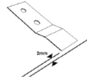
Entfernen Sie die Duschwanne und schrauben Sie die Bodenhalterungen M mit den Schrauben M am Boden fest. Das offene Ende der Halterung befindet sich 2 mm von der markierten Linie entfernt. Sie sollten gleichmäßig verteilt und parallel zu den Seiten neben den vorgesehenen Zugangsseiten zum Paneel angeordnet sein. Passen Sie das offene Ende der Bodenhalterungen M so an, dass es die Unterkante der Paneele A (nominal 1,5 mm) aufnehmen kann
