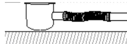
Installieren Sie die Rohrleitungen (nicht im Lieferumfang enthalten) gemäß den Bauvorschriften und schließen Sie den Abwasserauslass (nicht im Lieferumfang enthalten) an.
