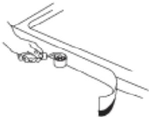
Rollen Sie den Dichtungstreifen mit einer kleinen Rolle oder einem anderen geeigneten Werkzeug so ab, dass er fest am Rand des Tablett anliegt und eventuelle Blasen oder Falten entfernt wurden. Achten Sie dabei besonders auf die Ecken. Entfernen Sie nach und nach den Abdeckstreifen und rollen Sie die Dichtung so auf, dass sie fest am Rand der Wanne anliegt. Achten Sie darauf, dass keine Lücken zwischen Wanne und Dichtungstreifen entstehen. Schneiden Sie überschüssige Streifen ab.
