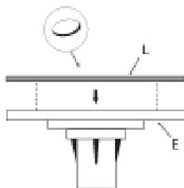
Befestigen Sie die kreisförmigen Klebepads L an der Unterseite aller kreisförmigen Grundplatten E, indem Sie das Trägerpapier NUR von einer Seite der Klebepads L entfernen, zentrieren Sie sie und drücken Sie sie in der richtigen Position fest.
