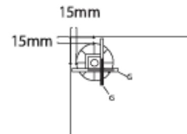
Passen Sie die Panel-halterungen G an, um einen Abstand von 15 mm zwischen der Halterung und der Wannenkante zu erreichen. An Ecken können die Panel-halterungen G an der Rückseite überlappen, falls eine engere Passung zum Rand der Wanne (mindestens 15 mm) erforderlich ist.
