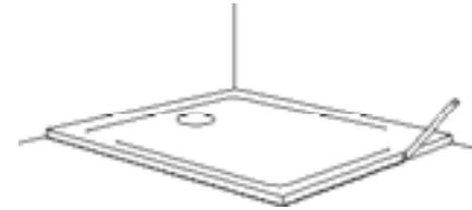
Platzieren Sie die Duschwanne auf dem Boden und markieren Sie die Position des Ablaufs sowie den Umfang der Wanne auf dem Boden.
