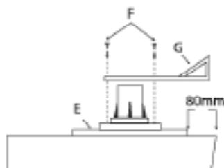
Befestigen Sie die aufrechten Panel-halterungen G mit zwei Schrauben E an den runden Grundplatten E, welche sich an den Paneelzugangsseiten der Wanne befinden.
