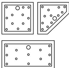
Legen Sie Ihre Duschwanne mit dem Boden nach oben und positionieren Sie alle Beine (NICHT DAUERHAFT BEFESTIGEN). Nutzen Sie nach Möglichkeit die alle verfügbaren Beine für eine maximale Unterstützung.
