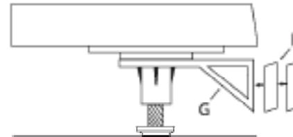
Entfernen Sie das selbstklebende Trägerpapier NUR von einer Seite der Klett pads H und befestigen Sie es an den Enden der Panel-halterungen G.
