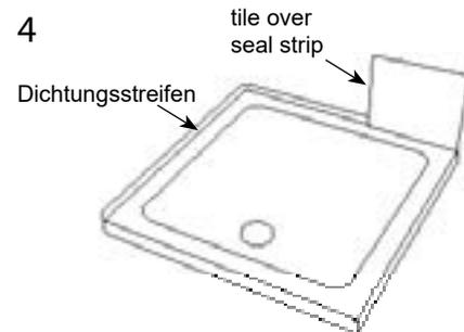
Bringen Sie die Duschwanne in Position und legen dann die Fliesen vor dem Dichtband. Dichten Sie nun mit Silikon zwischen der Wanne und den Fliesen ab und achten Sie darauf, dass das Silikon nicht mit dem Klebematerial auf dem flexiblen Dichtungstreifen in Berührung kommt.
