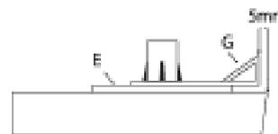
Sobald ein gleichmäßig unterstützter Layoutplan erstellt wurde, stellen Sie sicher, dass der Boden der Wanne sauber und frei von Staub und anderen Verschmutzungen ist. Entfernen Sie dann das restliche Trägerpapier von den Klebepads L an den Grundplatten E und befestigen Sie alle Grundplatten dauerhaft an ihrer Position.
