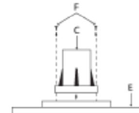
Schrauben Sie alle Beinmontagehalterungen C mit den Schrauben F an die Oberseite der kreisförmigen Grundplatten E.
