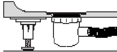
Befestigen Sie den Abwasserablauf mit Silikon an allen Passflächen an der Duschwanne. Die Duschwanne und alle Anschlüsse **MÜSSEN** nun auf Dichtheit, Durchfluss und ausreichende Entwässerung im gesamten Bereich überprüft werden.
