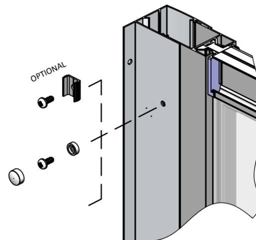
Wenn die Duschtrennung bereit zum Befestigen ist, bohren Sie mit einem 3mm Bohrer durch die Löcher im Wandprofil (Achten Sie darauf, dass Sie nur durch eine Wandstärke bohren) und befestigen Sie dann den Rahmen mit den Teilen 10, 11\* und 12\*.
