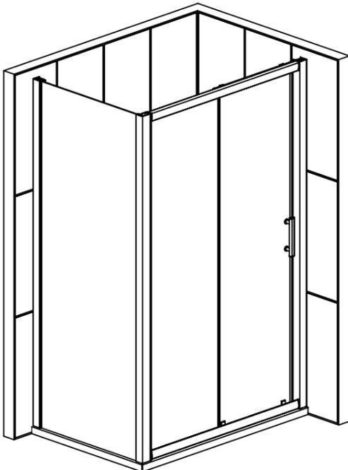
Schieben Sie die Seitenwand in das Rückwandprofil und schieben Sie dann das Eckprofil auf die Duschtrennung /die Tür.
