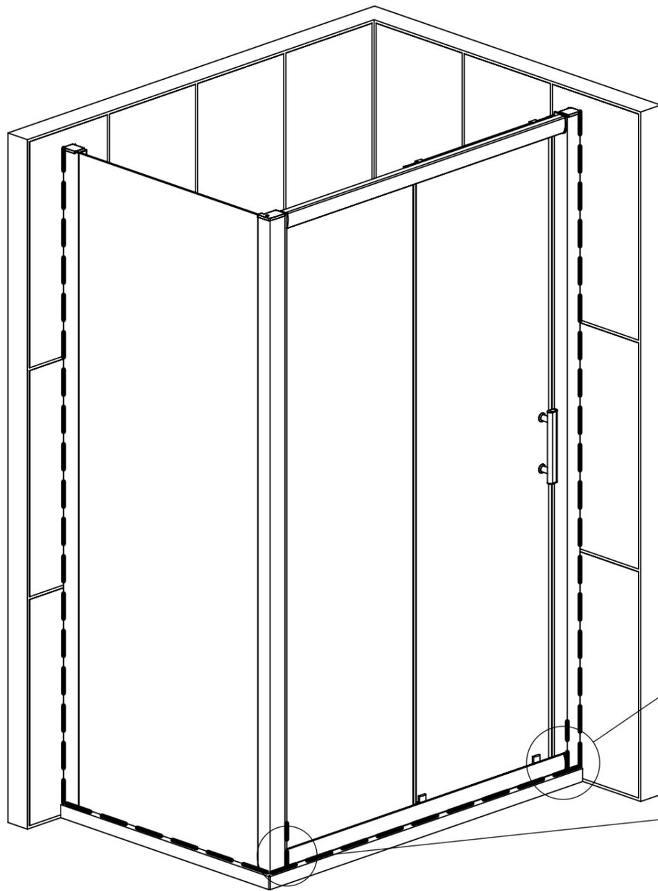
Dichten Sie nun beide Wandprofile sowie die Bodenprofile an der Stelle, an der sie auf die Wand treffen mit Silikon ab.
