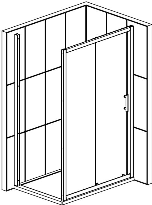
Das Seitenteil ist ein zusätzliches Element zur Duschtrennung/zur Tür. Befolgen Sie die ersten Schritte der Montageanleitung für Duschtrennungen/Türen bis zu dem Schritt, an dem Sie sich zwischen Eck- oder Nischenmontage entscheiden \*\*
