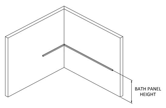
4. Befestigen Sie eine Holzlattenstütze (nicht im Lieferumfang enthalten) an der Wand. Verwenden Sie eine Wasserwaage, um sicherzustellen, dass die Holzstützen eben sind.
