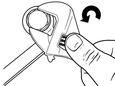
Entfernen Sie nun den Blindstopfen am höchsten Punkt des Heizkörpers mit einer Wasserpumpenzange.
