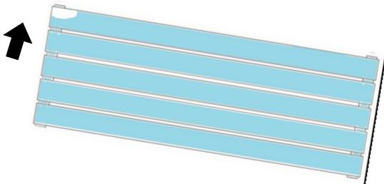
Heben Sie dein Heizkörper nun auf einer Seite etwas an. Dies bringt die Luft zum höchsten Punkt des Heizkörpers.
