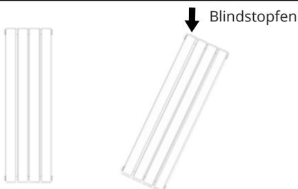
Während sich der Heizkörper noch auf der Schutzfolie befindet, positionieren Sie diesen schräg und entfernen den oberen Blindstopfen. Auf diese Weise können Sie das Heizelement in den Heizkörper einsetzen, ohne Glykol zu verlieren. Auch können Sie so überprüfen, ob der Glykolstand korrekt ist. \*Bitte beachten Sie Schritt 1 der "Temperaturprobleme" als Leitfaden zu dem korrekten Glykolstand.
