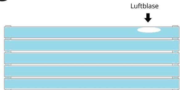
Bitte entfernen Sie den Heizkörper von der Wand und legen ihn flach auf einen ebenen Untergrund.
