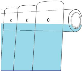
Falls Sie das Problem haben, dass der Heizkörper nicht richtig oder gar nicht aufheizt, könnte dies an einem zu niedrigen Glykolspiegel oder an eingeschlossenen Luftblasen im Heizkörper liegen. Dies verhindert, dass die Flüssigkeit die Löcher im Kollektor erreicht und die Wärme kann nicht im Heizkörper zirkulieren.
