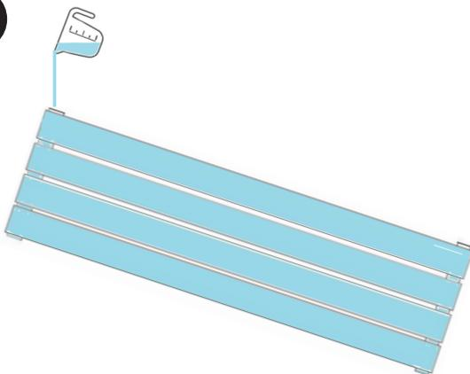
Falls notwendig, können Sie nun auch den Heizkörper, bis knapp unter dem Rand, mit Wasser auffüllen. Verschließen Sie den Heizkörper wieder mit dem Blindstopfen.
