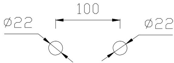
1. Bohren Sie zwei Löcher in die Wand
