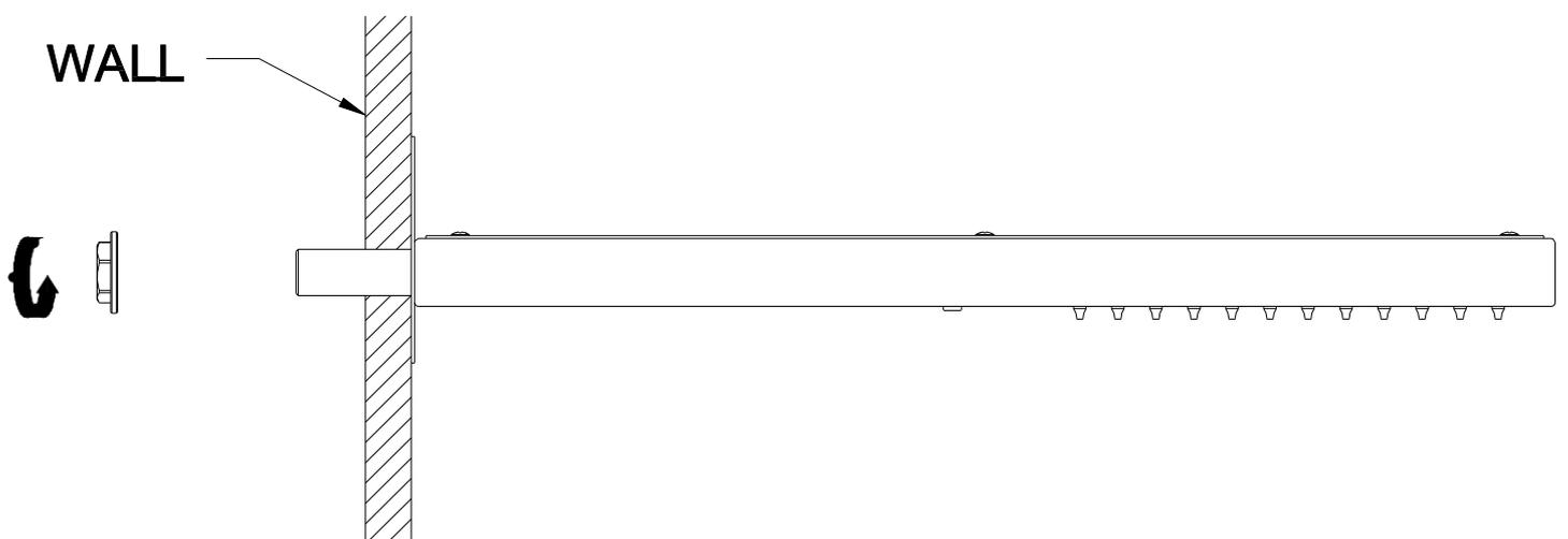
3. Führen Sie die beiden Einlässe durch die Wand. Befestigen Sie die Muttern und schließen Sie die Schläuche an.
