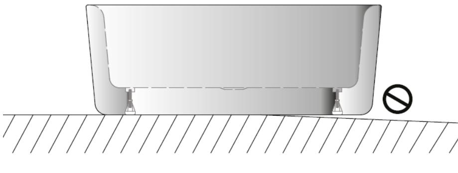
Überprüfen Sie, dass die Wanne gerade steht; wenn nötig, justieren Sie die Füße, um Bodenunebenheiten zu kompensieren
