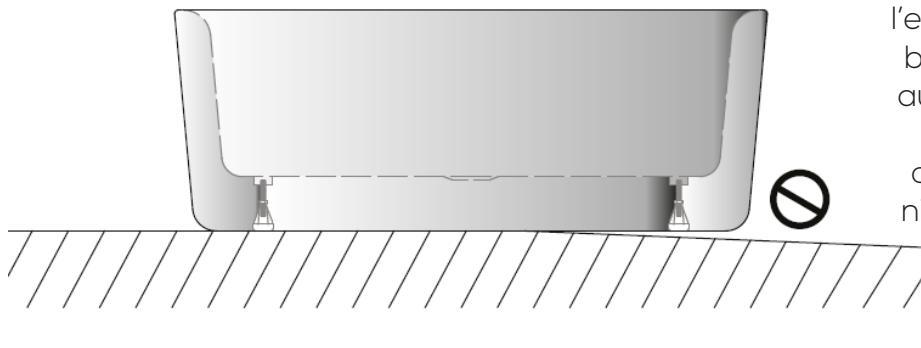
Assurez-vous que l'emplacement de la baignoire est plat ; au besoin régler les pieds pour contrebalancer le niveau du plancher
