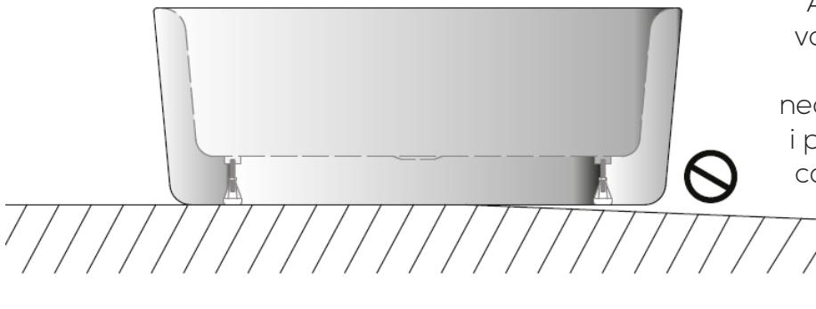
Accertarsi che la vasca sia poggiata piana ; se necessario , regolare i piedini in modo da compensare livello del pavimento.
